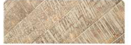
c-Ganita: Su bazlı yarı örtücü boyanın üzerine su bazlı örtücü boya sürülür. Kuruma işlemi tamamlandıktan sonra düşük kumlu zımpara ile temizlenerek oluşan özel bir renktir.
