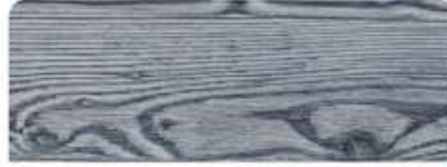
b-Tao: Su bazlı örtücü siyah boyanın üzerine düşük reçineli beyaz patina boya sürülür ve kuruma işlemi tamamlandıktan sonra yüksek kumlu zımpara ile temizlenerek oluşan özel bir renktir.
